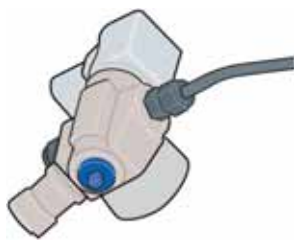
Ręczny zawór odcinający na zaworze głównym zbiornika
