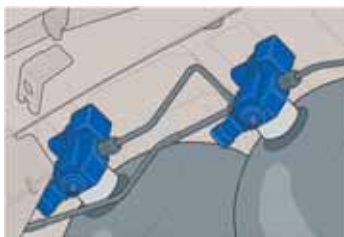
Elektromagnetyczne zawory odcinające na zbiornikach gazu
