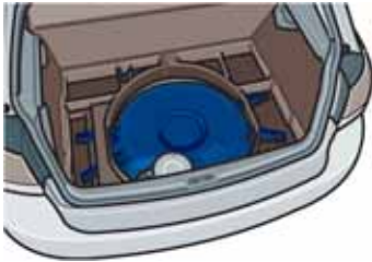
Zbiornik gazu LPG we wnęce na koło zapasowe (przykład Golf)
